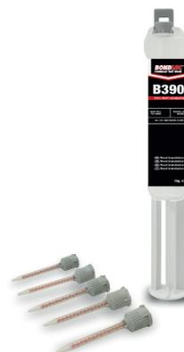
Двухкомпонентный быстрофиксирующий, цианоакрилат. Для разных поверхностей: пластмассы, резины и металлы. Заполнение зазоров до 5 мм. Гель предотвращает растекание даже на вертикальных поверхностях. Также пригоден для склеивания пористых материалов, таких как дерево, бумага, кожа и ткань.
