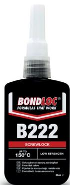
Низкопрочный резьбовой фиксирующий состав разработан для малоразмерных винтовых соединений, где важно предотвратить отвинчивание из-за вибрации и исключить протечки через резьбовое соединение, диаметр резьбы до М36.
