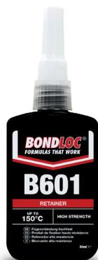
Вал-втулочный фиксатор подходит для всех типов цилиндрических соединений, таких как подшипники, шестерни, шлицы, шкивы. Продукт полимеризуется в зазорах до 0,15 мм имеет высокую степень фиксации и герметизацию соединения.
