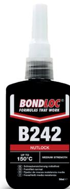
Резьбовой фиксатор средней фиксации, предназначенный для фиксации и герметизации резьбовых соединений. Используется с болтами редукторов, валов, резьбовых заглушек кожухов подшипников, диаметр резьбы до М36.
