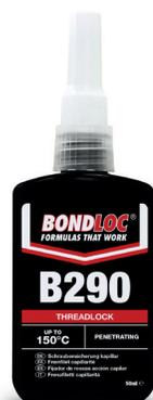
Фиксатор резьбовых соединений с очень низкой вязкостью, диаметр резьбы до M6, характеризующийся высокой степенью капиллярного затекания. Полимеризуется при отсутствии контакта с воздухом на примыкающих металлических поверхностях.
