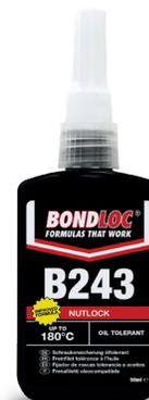
Однокомпонентный анаэробный фиксатор резьбовых соединений средней прочности, диаметр резьбы до М36. Предназначенный для легкой разборки с использованием ручного инструмента, допустимо использование продукта на замасленных, металлических поверхностях
