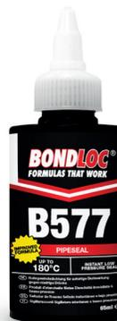
Резьбовой герметик высокой вязкости, предназначен для герметизации металлических резьбовых трубных соединений до M80, работающих в условиях высоких нагрузок. После полной полимеризации способен выдерживать давление до 350 Бар.
